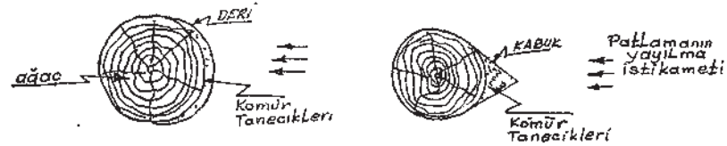
Şekil-7- Bir toz patlamasından sonra ağaç direkleri üstündeki bir deri (solda) ve bir kabuk (sağda)
